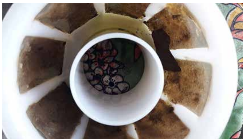
Resíduos de biodiesel na engrenagem das bombas comprometem o seu funcionamento.
